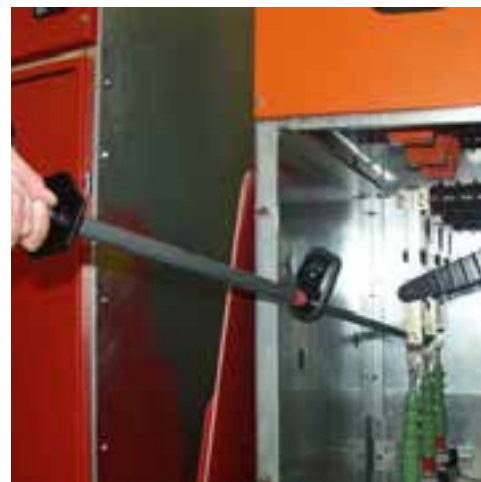
Spänningsprovare PHG II under användning i typtestat ställverksfack.
