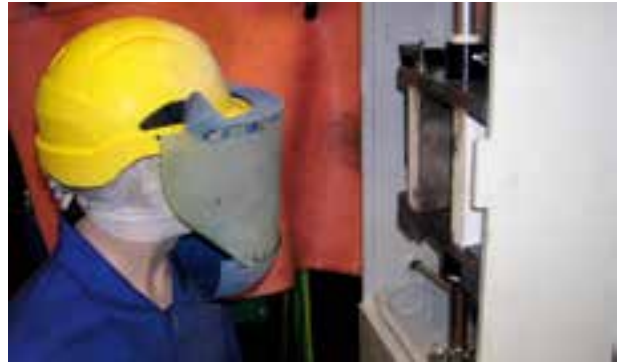
Boxtest klass 2 enligt EN 61482-1-2 W_{LBP} 318 \text{ kJ} = (E_{io} 423 \text{ kJ} / \text{m}^2)
