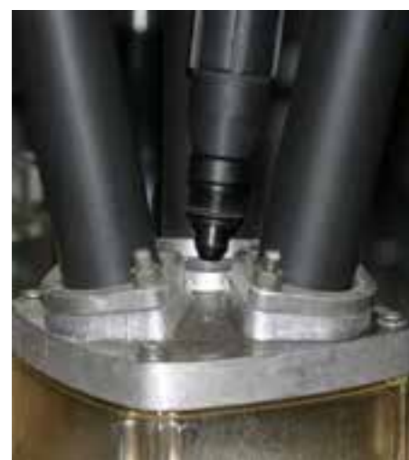
Montering av en specialanpassad påfyllningsplugg i kabelmuff med en vinklad manöverdel.
